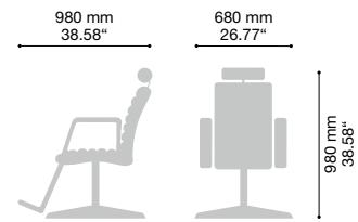
**DE** Traditioneller Herrenstuhl – klassischer Anspruch und exzellente Funktion // Rücken stufenlos verstellbar mit Gasfeder, feste (3110) oder bewegliche Fußbank (3100), ölhdraulische Höhenverstellung dreh- und feststellbar, Kopfhalter wahlweise //
