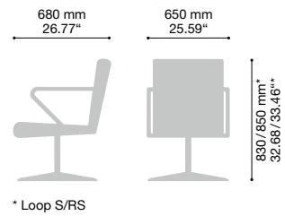
**DE** Premium Style – exklusiv in Materialität und Verarbeitung // Sitz und Rücken getrennt, Rücken starr oder Sitz und Rücken synchron verstellbar (S) oder vierfach rastbare Synchronverstellung (RS), Auslösehebel rechts oder links, Armschwingen Aluguss verchromt, Polsterkern in Schwarz abgesetzt//
