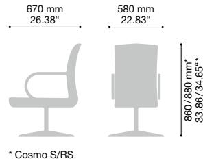
**DE** Beeindruckende Ästhetik – der Klassiker der Zukunft // Sitz und Rücken getrennt, Rücken starr oder Sitz und Rücken synchron verstellbar (S) oder vierfach rastbare Synchronverstellung (RS), Auslösehebel rechts oder links, Rückenschwinge chrom, schwarze PU-Armauflagen//
